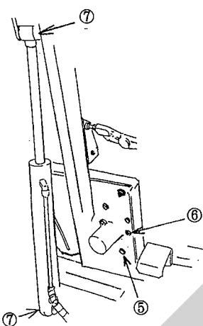
符号⑥ 油圧モータ取り付けボルト
