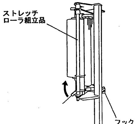
② フィルムホルダー（シャフト）をストレッチフレーム上部フック部より外し、手前側に倒します。
