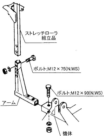
(5) ダブルストレッチアタッチ (AST1050W) の組み込み
