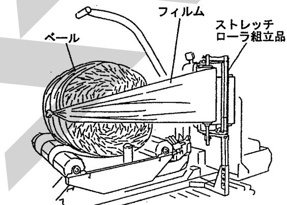
※ フィルムをペール側トワインに結びつける工程は、フィルムを新規に組込み挿入したときのみ行います。
