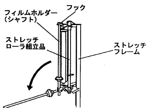
③ フィルムホルダー（シャフト）より、ベータピン・ローラを抜き取りフィルムを挿入します。
