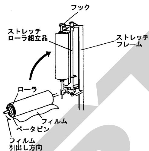
④ フィルムは、巻き方向が上から見て反時計方向になるよう挿入し、ストレッチローラに通します。
