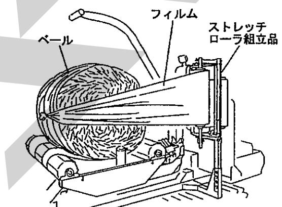
※ フィルムをベール側トワインに結びつける工程は、フィルムを新規に組込み挿入したときのみ行います。
