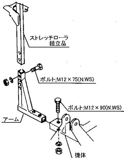
特殊3点リンク式のロータリーを使用している場合には、トップリンクの連結部を外し、標準3点リンク用の長いトップリンクを使用してください。
