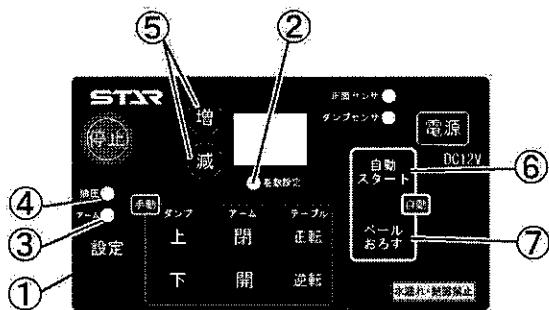
MWM1060W・MWR1060Wのソウサボックスは、「巻数」、「油圧」、「アーム」の設定ができます。①の「設定」ボタンを押すたびに、②「巻数設定」→③「アーム」→④「油圧」の順にランプが点灯し、表示が切り替ります。
