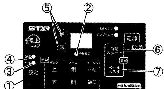
MWM1060W・MWR1060Wのソウサボックスは、「巻数」、「油圧」、「アーム」の設定ができます。①の「設定」ボタンを押すたびに、②「巻数設定」→③「アーム」→④「油圧」の順にランプが点灯し、表示が切り替ります。
