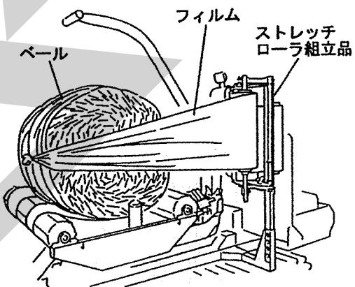
※ フィルムをベール側トワインに結びつける工程は、フィルムを新規に組込み挿入したときのみ行います。
