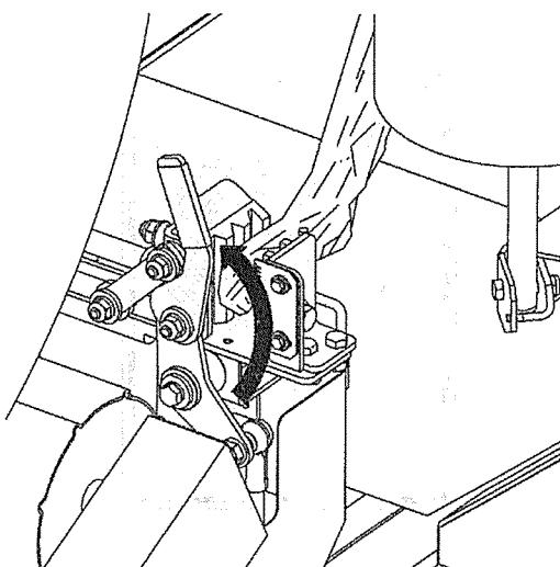
※ フィルムをカットホールド部にセットする工程は、フィルムを新規に組込み挿入し
