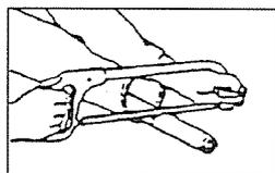
切断する時は、パイプの中にウエスを詰め、パイプ内面に切り粉が付着するのを防いでください。
