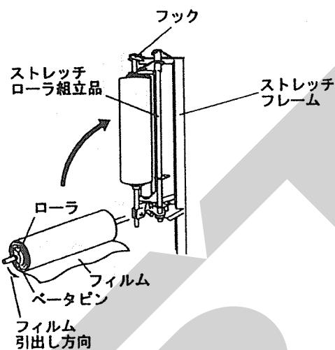
④ フィルムは、巻き方向が上から見て反時計方向になるよう挿入し、ストレッチローラに通します。
