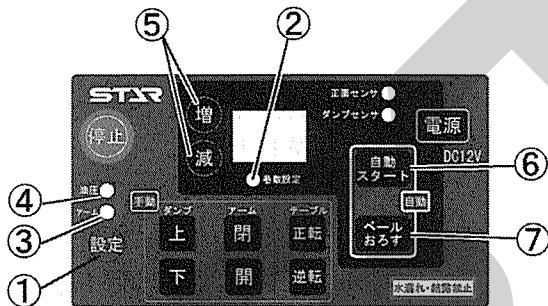
MWM1070W・MWR1070Wのソウサボックスは、「巻数」、「油圧」、「アーム」の設定ができます。②「巻数設定」の表示状態で①「設定」ボタンを長押しすると③「アーム」にランプが点灯し、表示が切り替わります。③「アーム」表示状態で①「設定」ボタンを押すたびに④「油圧」→②「巻数設定」の順にランプが点灯し、表示が切り替わります。
