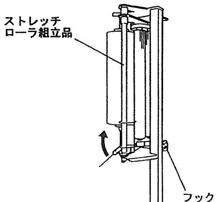
② フィルムホルダー（シャフト）をストレッチフレーム上部フック部より外し、手前側に倒します。
