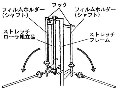
(3) フィルムホルダー（シャフト）より、ベータピン・ローラを抜き取りフィルムを挿入します。
