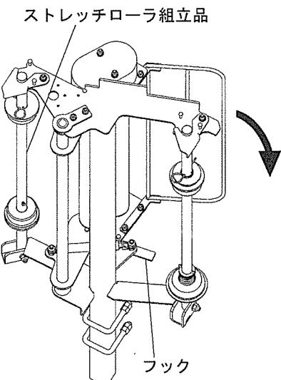
(2) フィルムホルダー（シャフト）をストレッチフレーム上部フック部より外し、手前側に倒します。
