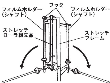
(3) フィルムホルダー（シャフト）より、ベータビン・ローラを抜き取りフィルムを挿入します。フィルム挿入後、ローラ・ベータピンを挿入し、上方に押し上げ、フィルムホルダ（シャフト）上部でストレッチフレーム上部フックと固定します。
