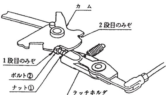
② 各ロッドの長さを調整、それぞれアームに接続後、スプリングの張りを調整します。
