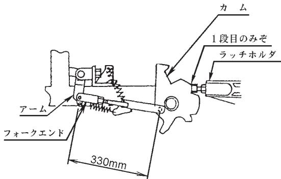
④ 前述①～③の調整後、再度ターンテーブルを手で回転させ、カムのみぞ1段目・2段目にラッチホルダが入り、また、ターンテーブル2回転目にラップホルダが開くことを確認してください。
