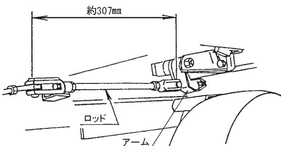
② 実際にターンテーブルを回転させ、ラップホルダを開きダンプを「上昇」させ、ラップホルダの閉じる位置を確認してください。
