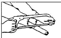
(4) 切り口をヤスリなどでなめらかに仕上げてからパイプをよく清掃し、次にグリースを塗布して、アウタとインナを組み合せます。
