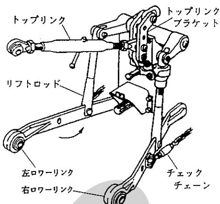
特殊3点リンク式のロータリーを使用している場合には、トップリンクの連結部を外し、標準3点リンク用の長いトップリンクを使用してください。
