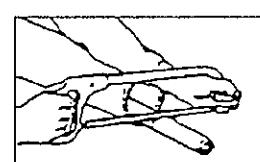
切斷する時は、パイプの中にウエスを詰め、パイプ内面に切り粉が付着するのを防いでください。
