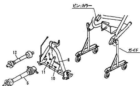
(6) ロワーリンクの地上高が40cm位で、オートヒッチフレームの姿勢が後傾5°位になるようにトップリンクの長さを調整してください。
