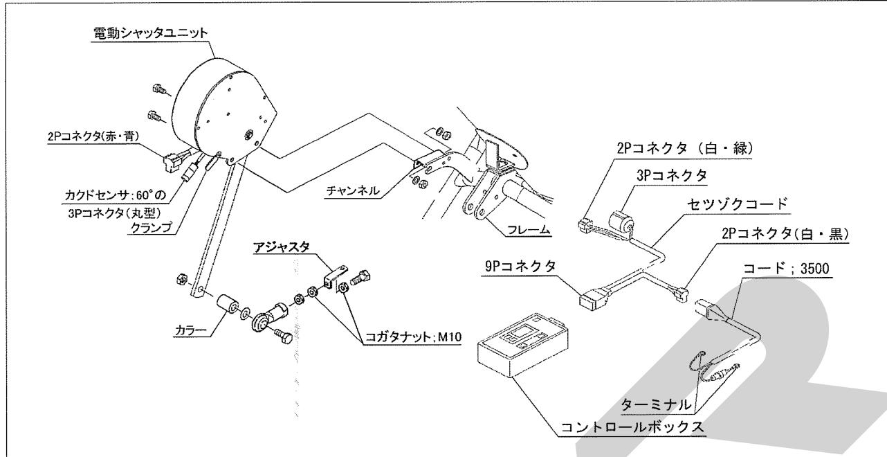
コード；3500がコントロールボックスに接続され、電動シャッタユニットまで接続した状態で行うと、誤作動する事があります。
