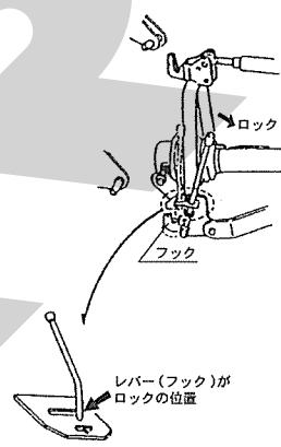
4 S タイプまたは 0 S タイプでお手持ちのオートヒッチフレームが 4 S タイプの場合はさらにパワージョイントが接続されていることを確認してください。
