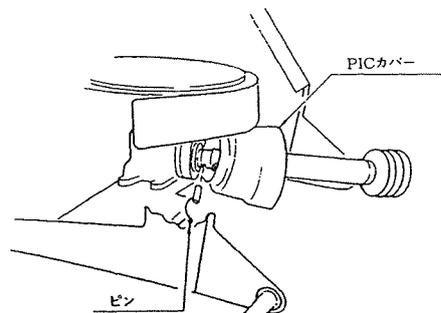
② 外したPICカバーを再びギヤボックスに挿し込んでください。
