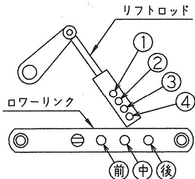
3点リンク最上時、シャット開閉レバーがトラクタに干渉するものがあります。純正ロータリ用ヒッチ以外で本作業機を装着する場合は、リフトロッド穴を4（最下）、ローリンク穴を後で装着してください。
