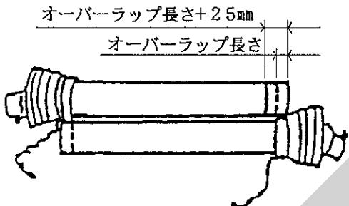
⑤ 3点リンクを昇降させて、PTO軸とPIC軸が最も離れる位置で、昇降を停止してください。
