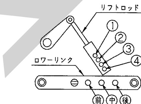
3点リンク最上時、シャッタ開閉レバーがトラクタに干渉するものがあります。純正ロータリ用ヒッチ以外で本作業機を装着する場合は、リフトロッド穴を4(最下)、ロワーリンク穴を後で装着してください。
