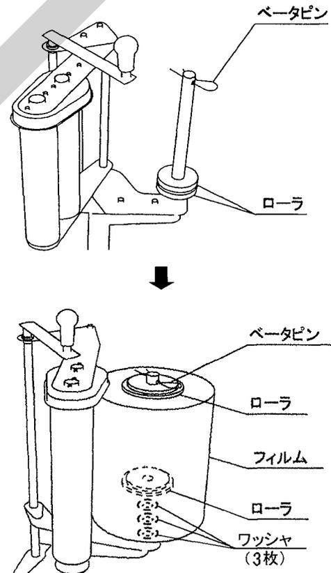
※フィルム筒の長さによっては、ベータピンと上部ローラにガタがあったり、フィルム筒が入らないことがあります。下部ローラ下のワッシャで調整してください。
