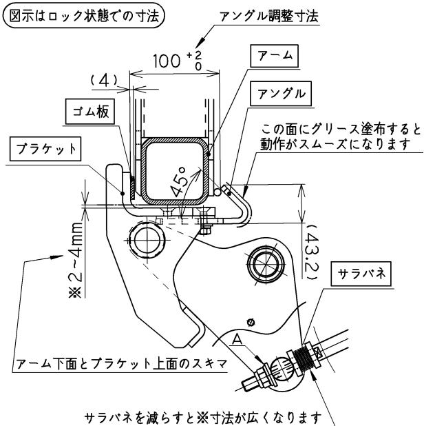
①アームをロックするブラケットとアングルの幅が 100~102 mmとなるように調整します。
