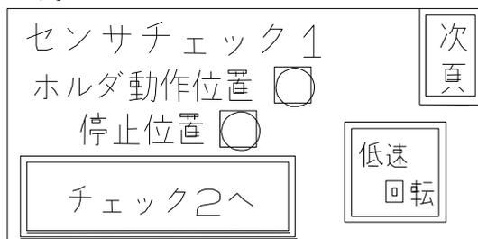
ホルダ動作位置…フィルムの切断・保持のため、ラップホルダが作動する位置の信号入力です。
