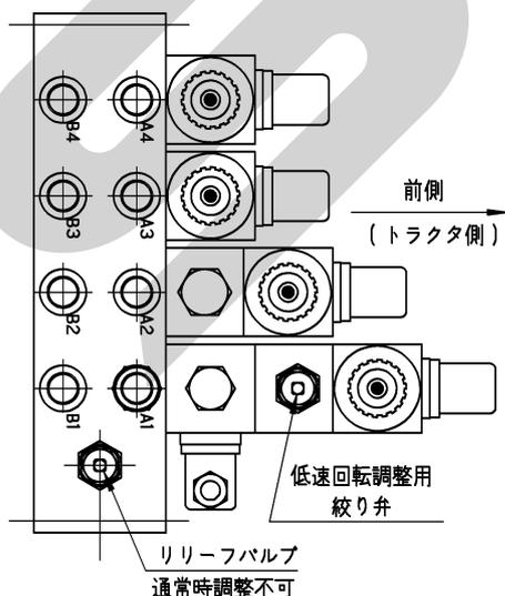
低速回転調整用の絞り弁は、時計回りに締めるとローテーションアームの回転が遅くなり、反時計回りに緩めると回転が速くなります。
