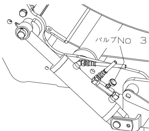
(4) 巻付け作業時の後ローラ高さ調整
