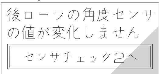
「3-3-2(1)-⑧ センサチェック2用画面」にて後ローラを『上』『下』に操作し、後ローラ高さの数値変化を確認する。
