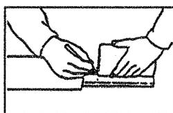
(3) パイプのアウトアとインナ両方を金ノコまたはカッターで切断します。
