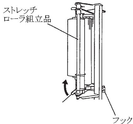
(2) フィルムホルダー（シャフト）をストレッチフレーム上部フック部より外し、手前側に倒します。
