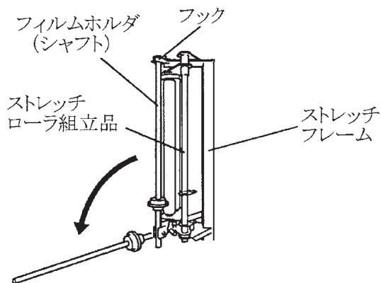
(3) フィルムホルダー（シャフト）より、ベータビン・ローラを抜き取りフィルムを挿入します。フィルム挿入後、ローラ・ベータピンを挿入し、上方に押し上げ、フィルムホルダー（シャフト）上部でストレッチフレーム上部フックと固定します。
