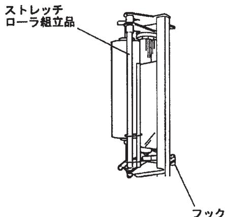
(5) フィルムは、巻き方向が上から見て反時計方向になるよう挿入し、フィルムを引き出してください。
