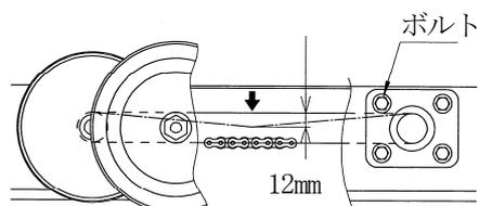
張りの強さはローラチェーンの中央部を指で押してたわみ量が12mmになるのが適正です。
