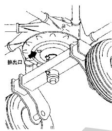
給油はオイルジョッキで計量後、指定の量を給油してください。ロータを水平においていた時、給油口がオイルレベル穴になっています。ロッククランプはシールテープを巻付け、取付けてください。
