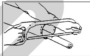
切断する時は、パイプの中にウェスを詰め、パイプ内面に切り粉が付着するのを防いでください。
