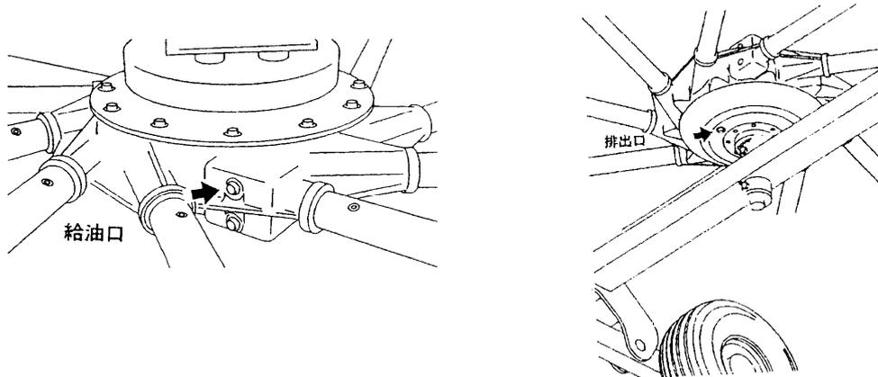
給油口は、オイルジャッキで計量後、指定の量を給油してください。ロータを水平においた時、給油口がオイルレベル穴になっています。
