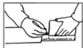
(3) パイプのアウタとインナ両方を金ノコまたはカッターで切断します。
