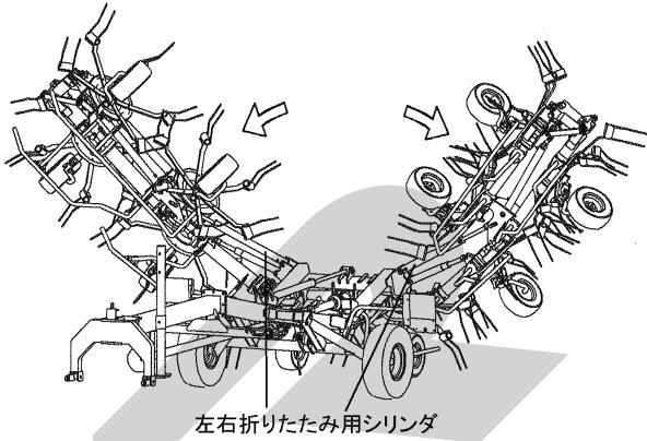
4. トラクタ油圧（外部取出）を操作し、ロータを広げてください。
