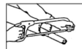
切断する時は、パイプの中にウエスを詰め、切り粉がパイプ内面に付着するのを防いでください。
