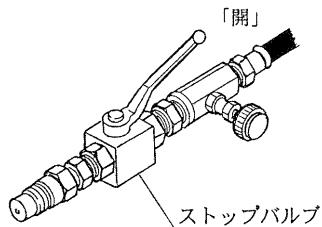
7. トラクタ油圧（外部取出）を操作し、移動輪を下げる、本体を持ち上げます。
