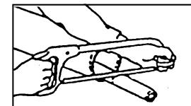
切断する時は、パイプの中にウエスを詰め、切り粉がパイプ内面に付着するのを防いでください。
