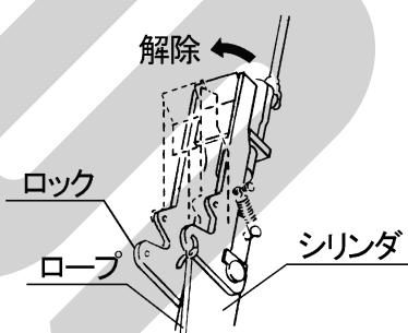
4. トラクタ油圧（外部取出）を操作し、ロータを広げてください。
