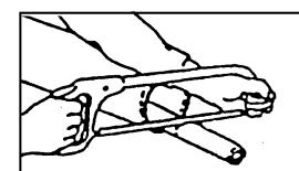
切断する時は、パイプの中にウエスを詰め、切り粉がパイプ内面に付着するのを防いでください。
