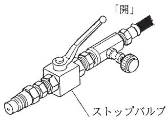
7. トラクタ油圧（外部取り出し）を操作し、移動輪を下げ、本体を持ち上げます。
