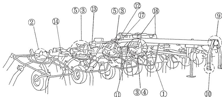
1. メインギヤボックス 2. ロータギヤケース 3. ロータギヤケース；A, B 4. トラニオン(インナ)
