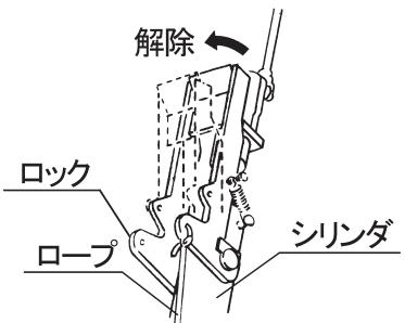
4. トラクタ油圧（外部取り出し）を操作し、ロータを広げてください。
