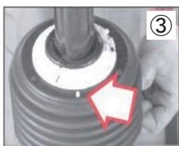
③ アウターコーンを取付、コーンの穴にベアリングリングの基準ピンを挿入します。
