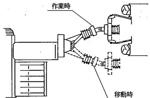
6. トラクタローリンクをパワージョイントが抜けない上限位置まで持ち上げてください。
