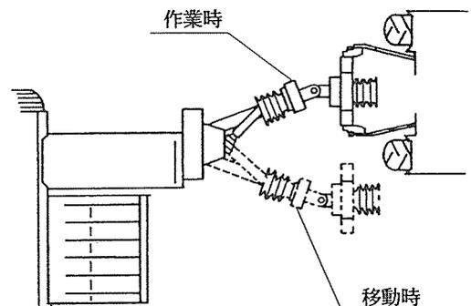
6. トラクタローリンクをパワージョイントが抜けない上限位置まで持ち上げてください。
