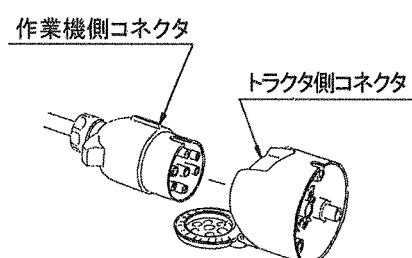
また、トラクタ側に外部電装品取り出し口が装備されていない場合は、別途トラクタ側コネクタの電気配線が必要となります。
