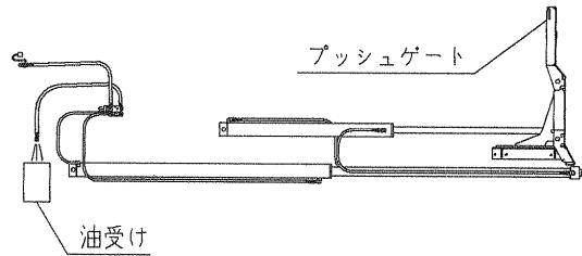
(5) プッシュゲートが最後端に移動したことを確認して油圧レバーを戻してください。
