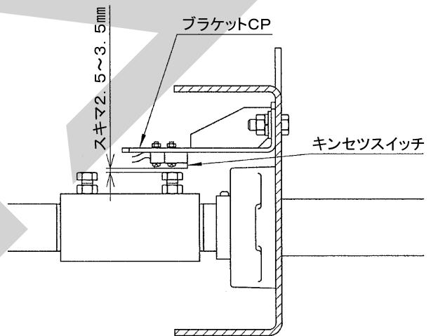
(1) フレーム内側のキンセツスイッチとボルト頭とのスキマが 2.5 ~ 3.5 mm になるように、アングルの高さを調整してください。
