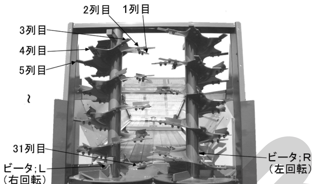
ブレード配列最上部より
