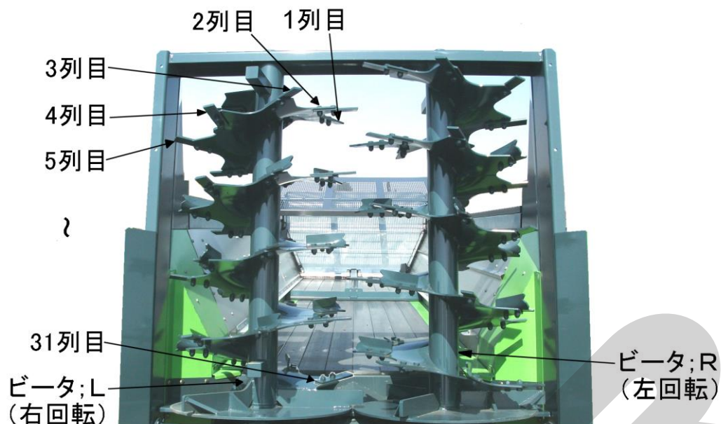
ブレード配列最上部より
