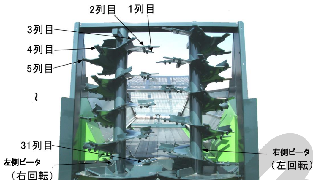
ブレード配列最上部より
