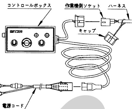
(1) 電源コードをバッテリーターミナルへ取り付けください。電源コードのターミナルは、トラクタのバッテリーターミナルをとめているボルトと共に締めにしますのでバッテリから $\ominus$ 、 $\oplus$ 共にコードを外してください。コードを外す時は、 $\ominus$ 側から外してください。又、取り付ける時は、 $\oplus$ 側から取り付けてください。
