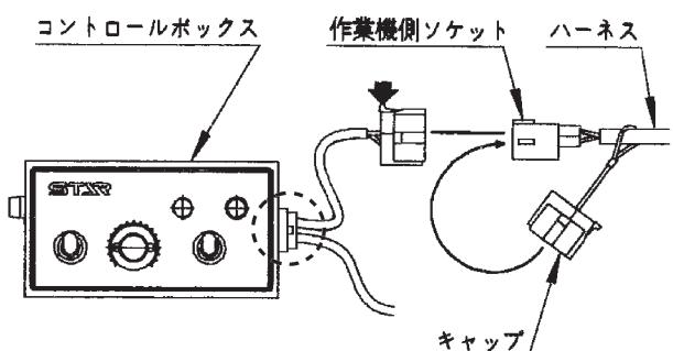
コントロールボックスから作業機側ソケットを外す時は、矢印部分を押しながら外してください。
