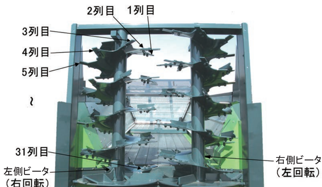
ブレード配列最上部より
