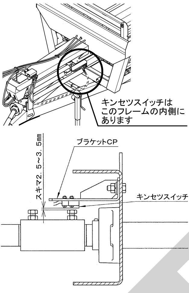
(1) フレーム内側のキンセツスイッチとボルト頭とのスキマが2.5~3.5mmになるように、アングルの高さを調整してください。
