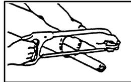
(4) 切り口をヤスリなどでなめらかに仕上げしてからパイプをよく清掃し、次にグリースを塗布して、アウトとインナを組み合せてみます。
