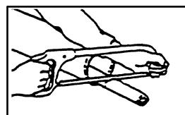
(4) 切り口をヤスリなどでなめらかに仕上げてからパイプをよく清掃し、次にグリースを塗布して、アウタとインナを組み合わせます。
