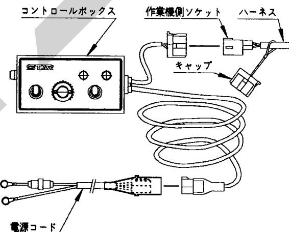
(1) 電源コードをバッテリーターミナルへ取り付けてください。電源コードのターミナルは、トラクタのバッテリターミナルをとめているボルトと共に締めにしますのでバッテリから $\ominus$ 、 $\oplus$ 共にコードを外してください。コードを外す時は、 $\ominus$ 側から外してください。又、取り付ける時は、 $\oplus$ 側から取り付けてください。
