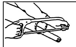
(4) 切り口をヤスリなどでなめらかに仕上げしてからパイプをよく清掃し、次にグリースを塗布して、アウトとインナを組み合わせます。
