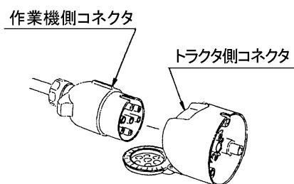
また、トラクタ側に外部電装品取り出しが装備されていない場合は、別途トラクタ側コネクタの電気配線が必要となります。
