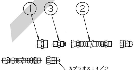
本作業機についているカプラオス；1/2をはずし、①ソケット、②ユアツホース、③ホースニップルを図のように取り付け、その先にカプラオス；1/2を取り付けてください。
