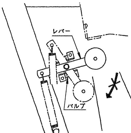
「 バケット内の収穫物を運搬車に移し終えたら、外部油圧操作レバーを逆方向に操作し、バケットが完全に降下してから走行を始めてください。尚、アウトリガーを装備した作業機はアウトリガーが完全に上昇してから走行を始めてください。
