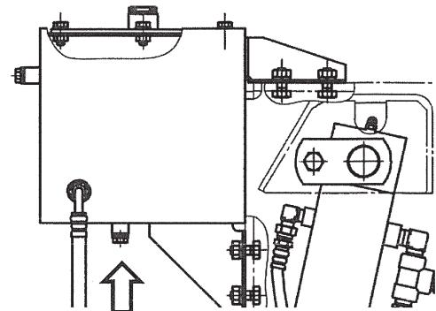
(11) 矢印部のドレンプラグからオイルが排出され始めたら、油圧発生源の油圧レバーを戻し油圧を止め、カプラ部に繋いだ油圧ホースを外してください。
