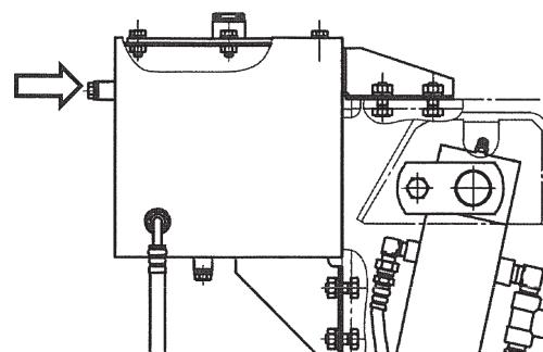
(12) 油圧シリンダの長さが図の様に約930mmになるまで縮め、(2)で取り外したピンとボルトを組み付けます。
