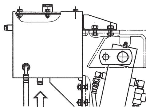
(9) 細い気泡（エア）が完全に無くなったらストップバルブの溝とザガネが右図の向き（開状態）になるよう9[mm]の工具などで回してください。
