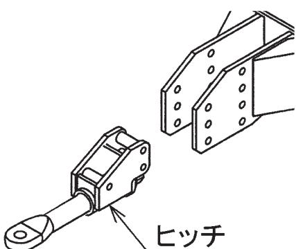
出荷時のヒッチ高さは695mmです。ヒッチの取り付け位置を変えることで、高さを575～815mmに変えることができます。
