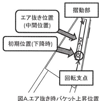
図A.エア抜き時バケット上昇位置
