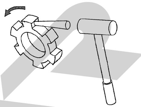
(5) 調整後、ロックプレートを確実に締め付けてください。
