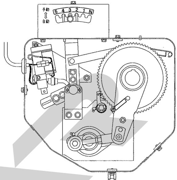
12. チェンジレバーを手で動かして、3速の位置の溝にスムーズにきちんと入る事を確認してください。
